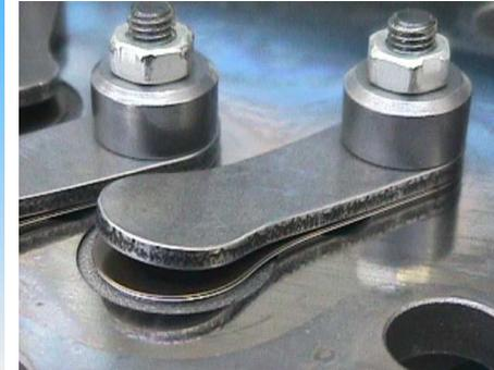
Válvulas de acero flexible de larga vida, especialmente resistentes a la erosión y los impactos
