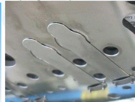
Válvulas de descarga tipo reed (lenguetas)
